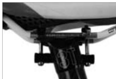
Подседельный штырь с двухболтовым замком крепления
