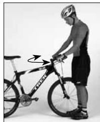
РИСУНОК 3: Функциональная проверка руля и выноса
