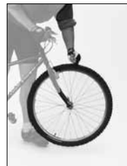
РИСУНОК 4: Проверка на ослабленное состояние
