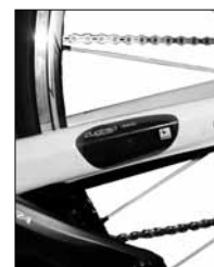
РИСУНОК 56: Крепление на перьях датчиков скорости и частоты педалирования компьютера, интегрированного с Duotrap
