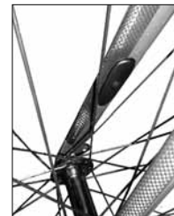
РИСУНОК 55: Крепление на вилке датчика скорости компьютера, интегрированного со Speedtrap
