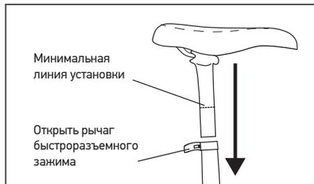
Рис. 8: Установка подседельного штыря глубже линии минимального крепления трубу рамы таким образом, чтобы было не видно отметку на подседельном штыре.
