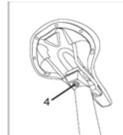
Можно регулировать угол наклона седла и двигать его вперед или назад.
