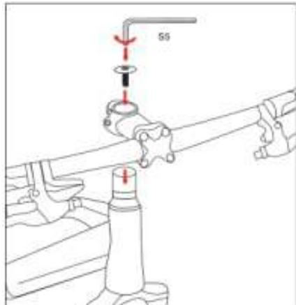
3. Установите руль на рулевую колонку, как показано на рисунке выше, убедившись в том, что ни один из кабелей не перекручен или не натянут слишком тугу (возможно, придется повернуть руль). Вставьте верхнюю крышку с винтом в рулевую колонку и затяните винт (в противном случае шариковые подшипники могут быть повреждены), так вы закрепите рулевую колонку. Убедитесь, что подшипники не перетянуты! Они должны легко вращаться.
