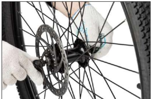
Затягиваем эксцентрик со средней силой. Затем протягиваем рулевой стакан. Проверяем, чтобы он не болтался, но в то же время крутился свободно
