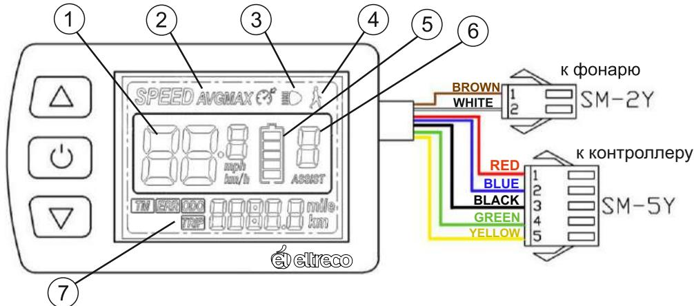
( - кнопка включения/выключения. Для активации/деактивации электромотора зажмите кнопку на 3 секунды.
