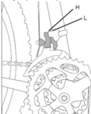
Накиньте цепь на самую маленькую звездочку системы и затяните регулировочный винт на рычаге. Отрегулируйте винт-ограничитель крайнего левого положения в передней части механизма переключения передач так, чтобы он находился на расстоянии в 1,5 мм от цепи. Переключитесь на большую звездочку кривошипной системы и самую маленькую звездочку/шестерню блока звездочек на заднем колесе.
