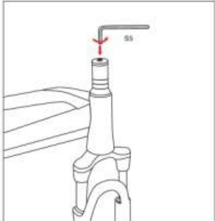
1. Снимите верхний винт штока вилки
