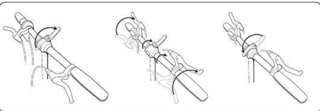
Отрегулируйте положение рулевой перекладины и зафиксируйте положение при помощи эксцентрика. Подберите удобный для себя угол расположения органов управления.
