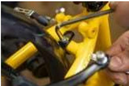
4е) Используя болт, шайбы и гайку крепления крыла к раме, закрепите крыло, предварительно отрегулировав его по высоте (шестигранник 5 мм, ключ накидной 10 мм).
