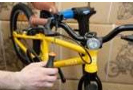
2j) Установите звонок из коробки с доп. деталями на руль (отвертка PH2).
