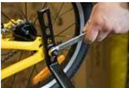
2f) Отрегулировав высоту положения доп. колес, затяните контргайки (ключ рожковый 15 мм, усилие 30 Nm).
