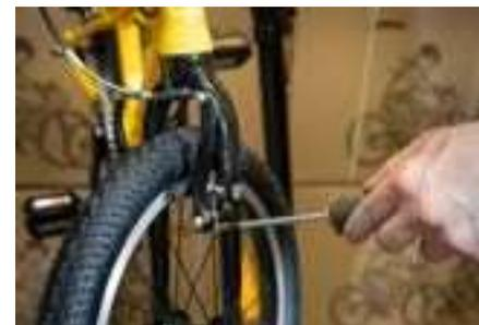
7e) Проверьте необходимость регулировки лапок тормоза. Они должны отводить обе колодки на одинаковое расстояние от обода.
