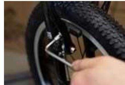
7d) Проверьте необходимость регулировки тормозных колодок. Они должны стоять параллельно ободу. Если необходимо, открутите на один оборот гайку крепления колодки и отрегулируйте положение колодки. Затяните гайку крепления колодки и проверьте снова положение (шестигранник 5 мм, усилие 5Nm).
