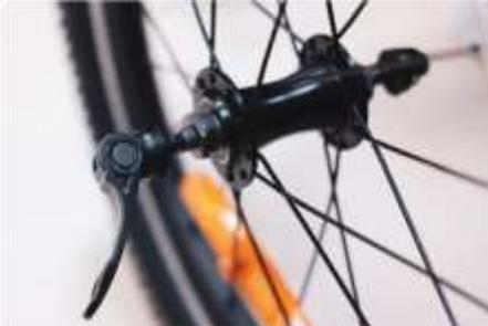
1b) Переверните велосипед и закрепите колесо в вилке, закрутив гайку с одной стороны эксцентрика и затянув рычаг с другой. Обратите внимание на стрелку Direction -> на крышке, указывающую направление вращения колеса.
