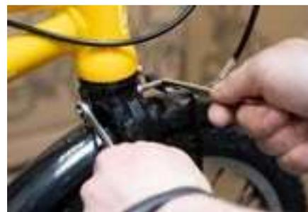
4) Установка заднего крыла (в зависимости от модели крыла, установка может отличаться) Для установки заднего крыла необходимо снять заднее колесо и доп. колеса, если они установлены.
