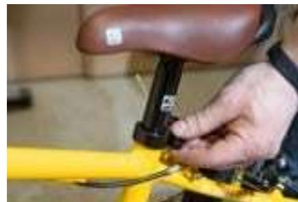
Обратите внимание! Если седло проворачивается при закрытом эксцентрике подседельного хомута, откройте эксцентрик подседельного хомута и подтяните руками гайку с обратной стороны эксцентрика подседельного хомута на пол оборота.
