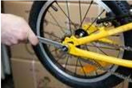
4b) Открутите гайки оси задней втулки (ключ рожковый 15 и 17 мм).
