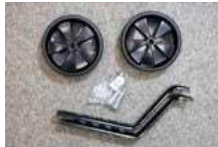
2а) Соберите доп. колеса, используя оси, шайбы, гайки, колеса и кронштейны (ключ рожковый 12, 13 мм, усилие 10 Nm).
