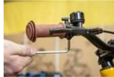
7c) Затяните болт крепления тормозной ручки (шестигранник 5 мм, усилие 5 Nm).
