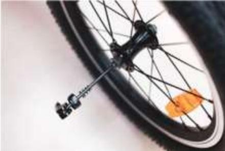
Переднее колесо крепится при помощи эксцентрика.
