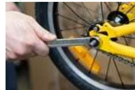
4i) Затяните болт крепления тормозного троса, установив тормозной трос в необходимое положение (см. пункт «Регулировка тормозов») (шестигранник 5 мм).
