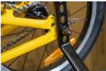
2e) Наденьте шайбы и накрутите контргайки на ось задней втулки.
