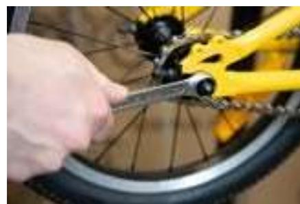
3с) Затяните гайки оси задней втулки (ключ рожковый 15, 17 мм, усилие 35 Nm).
