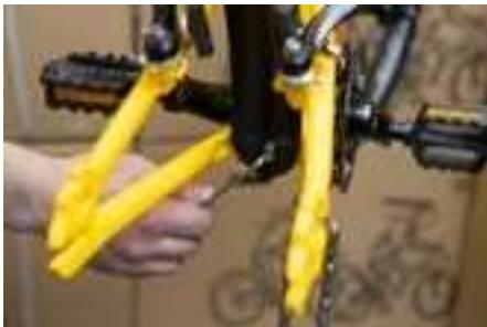
4f) Используя болт крепления крыла к креплению подножки, затяните болт (шестигранник 4 мм, отвертка рh2).
