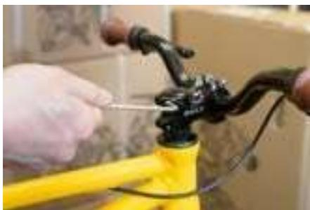
6 7 2h) Затяните оба болта крепления выноса (шестигранник 4 мм, усилие 5 Nm).
